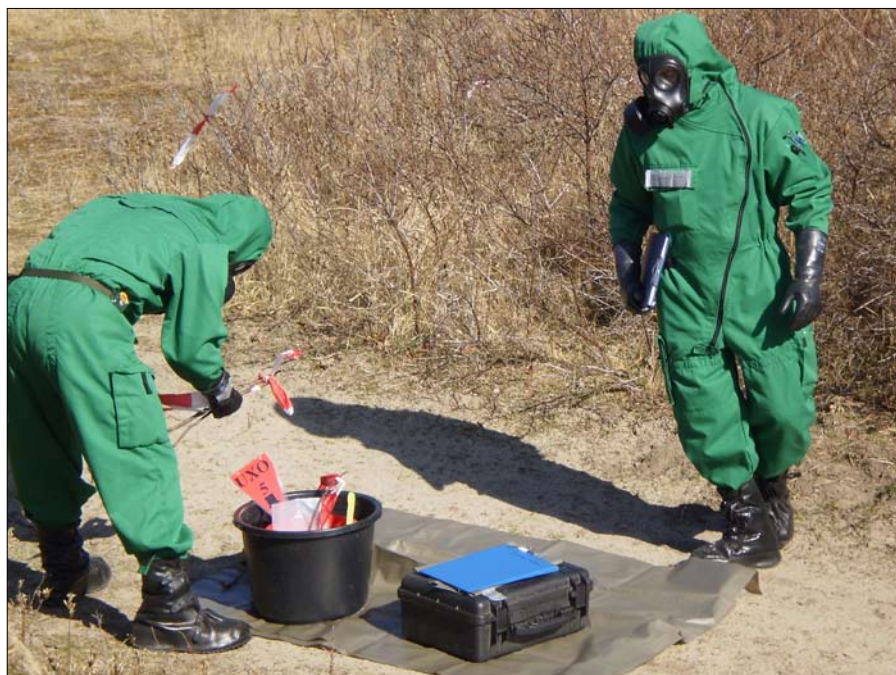
Säkerhet är a och o vid provtagningar. Skyddskläder med skyddsmask, tätt åtsittande gummihandskar och skor är nödvändiga för att förhindra eventuell exponering av farliga gaser.
