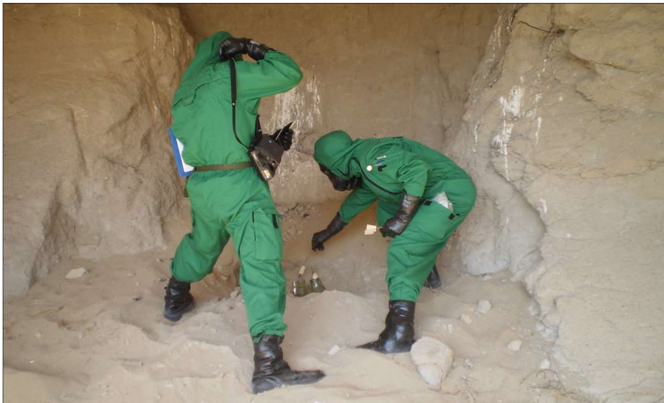
Provtagning av misstänkta kemiska vapen sker genom att föra ner ett prov i vätskan som sedan analyseras.
