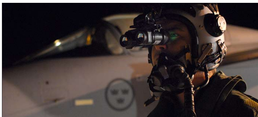
Night Vision Goggles gör att piloterna på hög höjd kan urskilja objekt på marken och samverkan med markförbanden förbättras.
